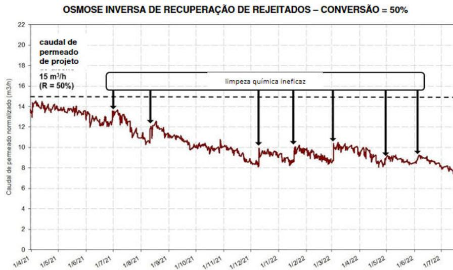
**Figura 2.** Caudal de permeado normalizado do OR de recuperação de rejeitados. Caudal de projeto afunorar com 50% de conversão e frequência de limpeza química.
