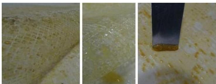
**Figura 4:** Aspeto da superfície da membrana e do espaçador de plástico para rejeição da alimentação fortemente contaminados com biofilme.
