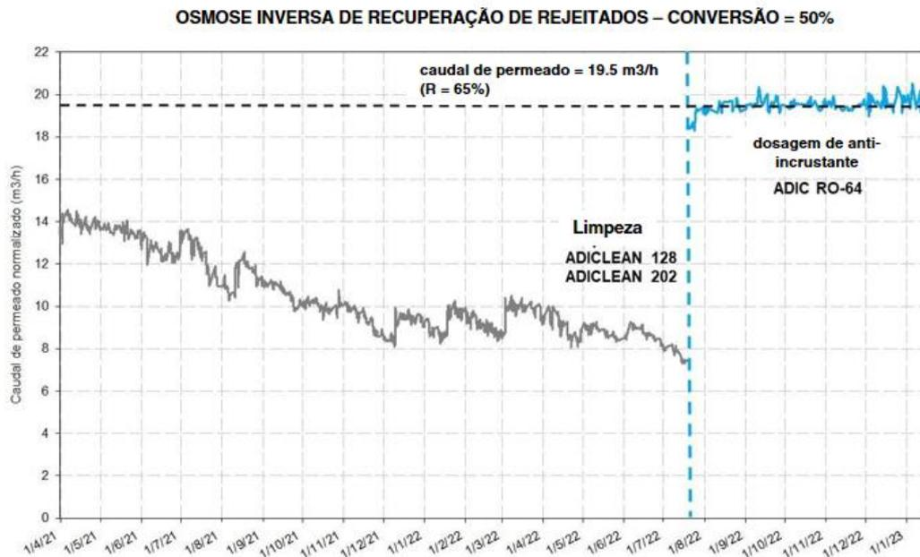
**Figura 5.** Evolução do caudal de permeado normalizado após a implementação das ações de melhoria.
