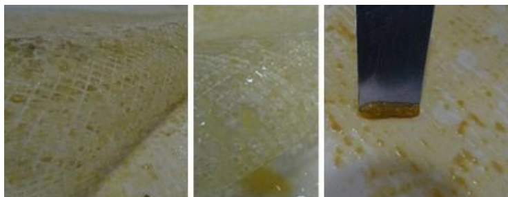
Figure 4 : Aspect de la surface de la membrane et de l'espaceur en plastique pour le rejet des aliments, fortement contaminés par le biofilm.
