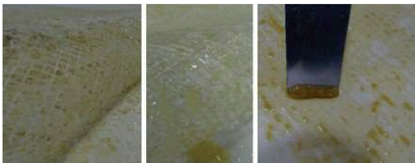
FIGURA 4. Aspecto de la superficie de la membrana y del espaciador plástico alimento-rechazo contaminados de forma abundante por biopelícula
