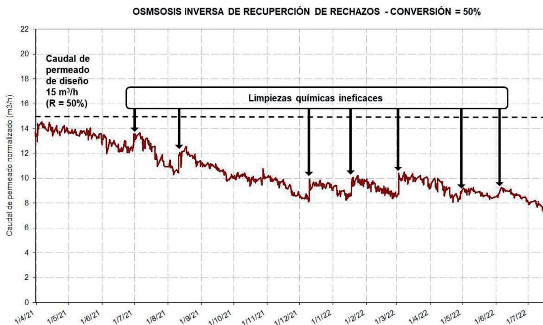
FIGURA 2. Caudal de permeado normalizado de la osmosis inversa de recuperación de rechazos. Caudal de diseño operando a una conversión del 50 % y frecuencia de las limpiezas químicas
