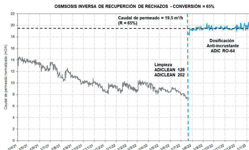
FIGURA 5. Evolución del caudal de permeado normalizado después de aplicar las acciones de mejora
