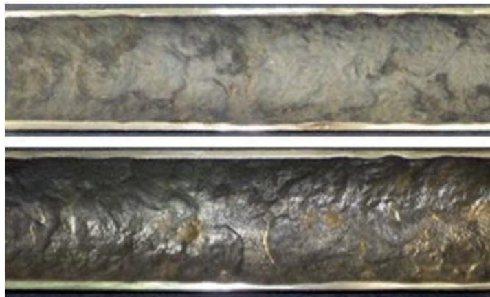
FIGURE 3 - Tubes de l'échangeur de chaleur bloqués en raison d'une accumulation importante de dépôts
