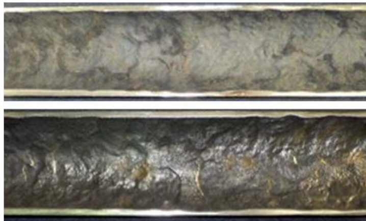
FIGURA 2. Tubos de la instalación afectados por corrosión bajo depósito
